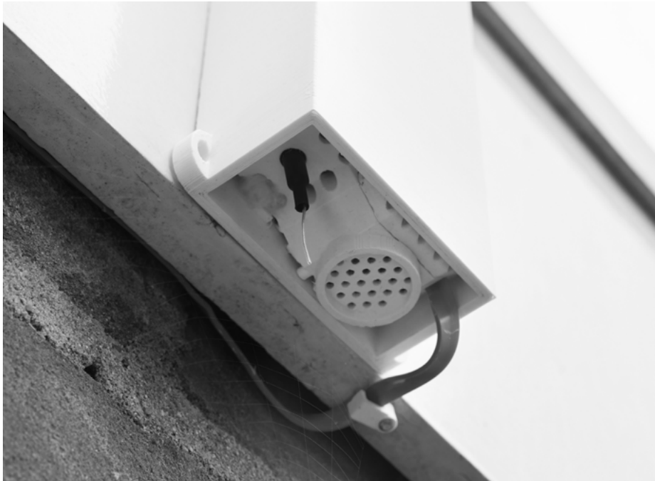
De Heusinkveld-sensor in een 3D-geprint, duurzaam en weerbestendig kastje. ♦ Foto Guy Ackermans
