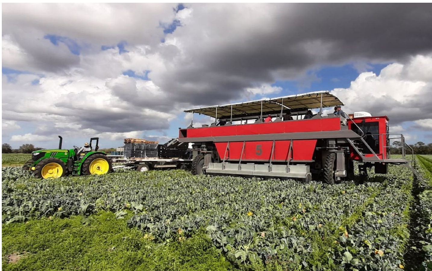
De computer gestuurde broccoli-oogster • Foto Pieter Blok
