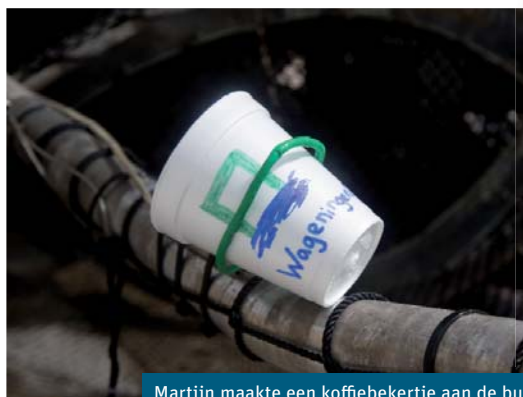
Martijn maakte een koffiebekertje aan de buitenkant van de duikboot vast, om te zien wat de hoge druk ermee zou doen.
