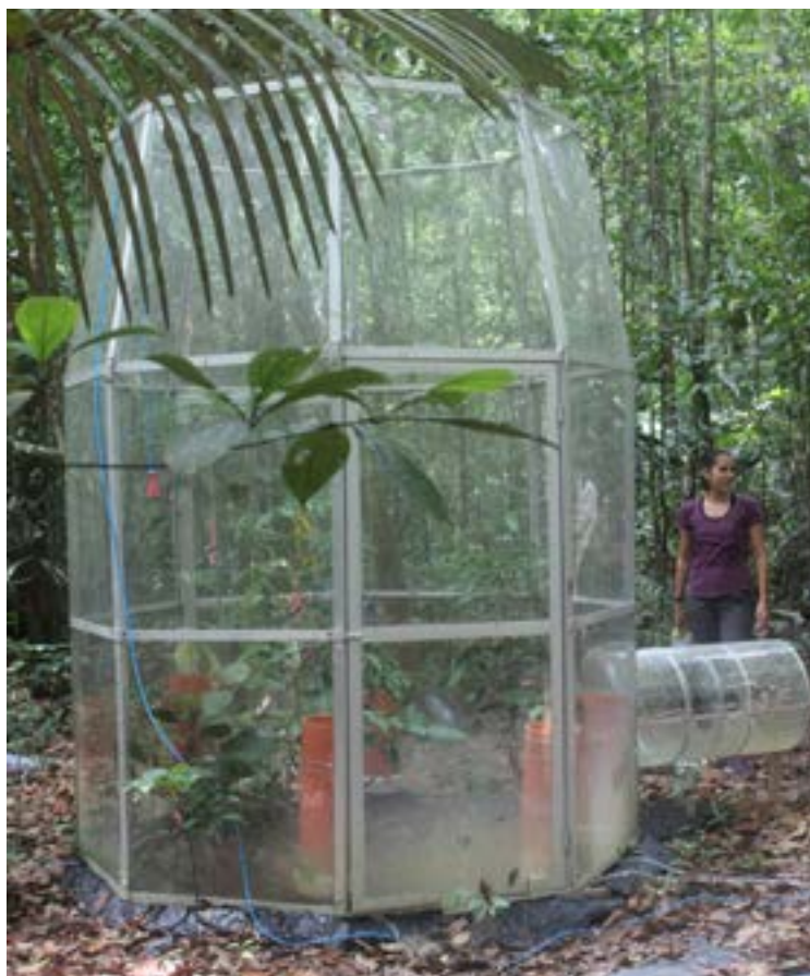
► Een Open Top Chamber waarmee INPA onderzoekt wat de verwachte klimaatverandering met het bos doet. In vier van deze kasjes krijgen de bomen extra CO 2 toegevoerd; de andere vier vormen de controlegroep.
