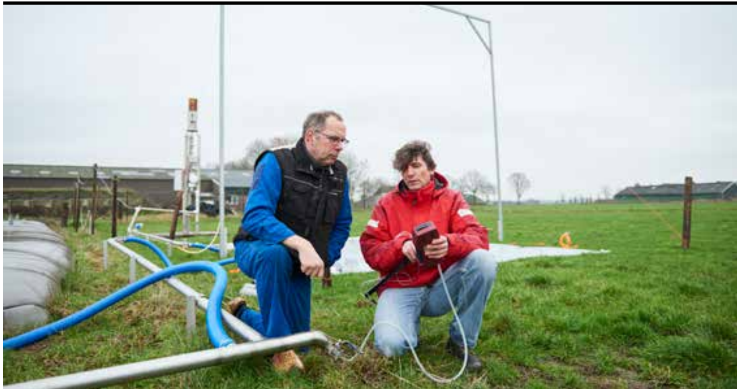
▲ Boer Peter van Roessel (links) en projectleider Roland Melse van WUR inspecteren de proefopstelling voor methaanverbranding op het bedrijf van Van Roessel.
