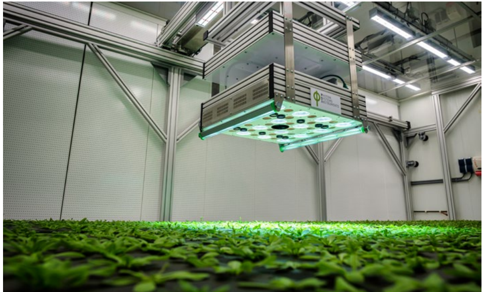
In de klimaatkamers is volledige controle over het opvallende licht. Dat maakt het mogelijk om diverse aspecten van de fotosynthese in kaart te brengen, zoals op deze foto gebeurt met de modelplant Arabidopsis (zandraket). • Foto Guy Ackermans
