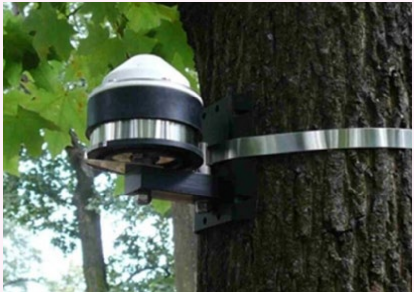
Dendrometers leggen veranderingen in stamdiameter nauwkeurig vast • Foto Bas Lerink
